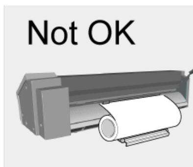
**D Spostare i rullini pressori fino ai bordi del materiale, cosicché ciascuno di essi si trovi all'interno dei segni di trascinamento.**
